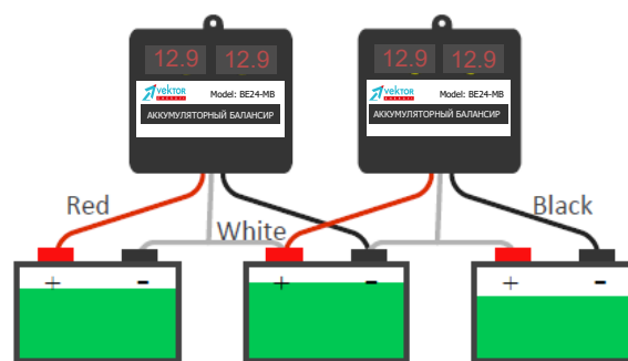
рис. 3 Банк батарей на 36В из 3-х АКБ
